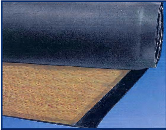
**Características:** Compuesto por fibrasonic y cortasonic que si bien tienen parecida densidad, presentan gran diferencia en cuanto a su elasticidad, fragilidad y adherencia entre la lámina pesada y la capa fibrosa. Este material debido a su estructura tiene por un lado una alta capacidad absorbente debida a las características del fibrasonic a la que hay que añadir la alta capacidad de aislamiento, debido a la especial composición de la lámina de alta densidad que actúa de barrera al ruido.
